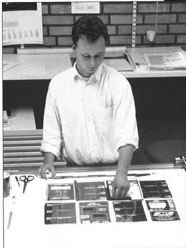
Tomas Ivarsson monterar ihop sidorna till ett transparent original som sedan används för att framställa själva offset-plåten. Denna lämnas därefter till ett tryckeri som med hjälp av plåten sätter av svärtan på rätt ställe på papperet.
